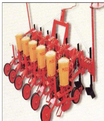
شکل ۱۲- نوعی ردیف‌کار چغندر قند و جدول تغییر میزان تراکم با استفاده از تغییر چرخ‌دنده‌ها
