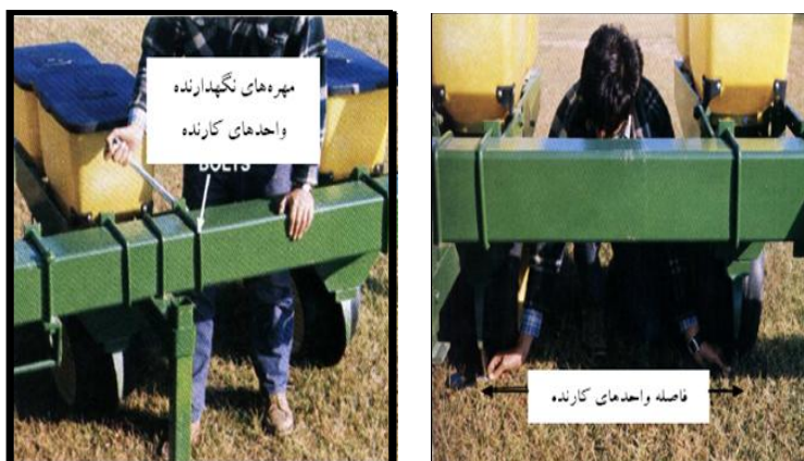
شکل ۱۰- شل کردن مهره‌های نگهدارنده جهت تنظیم فاصله ردیف‌ها
