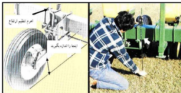
شکل ۹- تراز ردیف‌کارهای اتصال دو نقطه و سه نقطه
